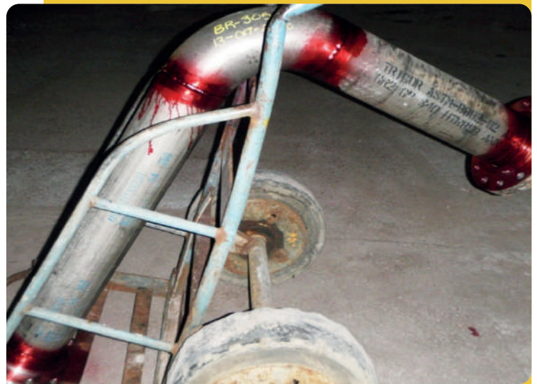
FABRICACIÓN DE LINEAS DE REFLUJO DE 6" DE DIAMETRO DE TITANIO
